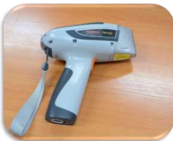
Рентгено-флуоресцентный спектрометр Thermo NITON XL3t-950 Goldd(3 шт., про-во Россия).
