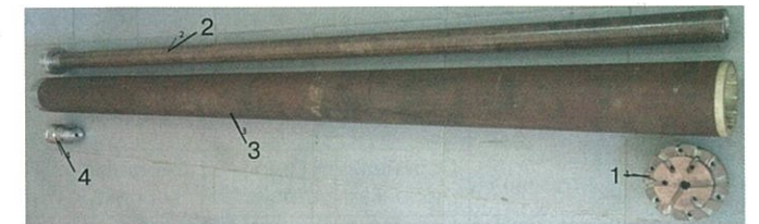
Рис. 2. Гидроустройство с возобновляемым, забойным источником энергии со сплошным забоем бурения скважин: 1 — составное долото; 2 — шпindel; 3 — наружная труба; 4 — переходник
